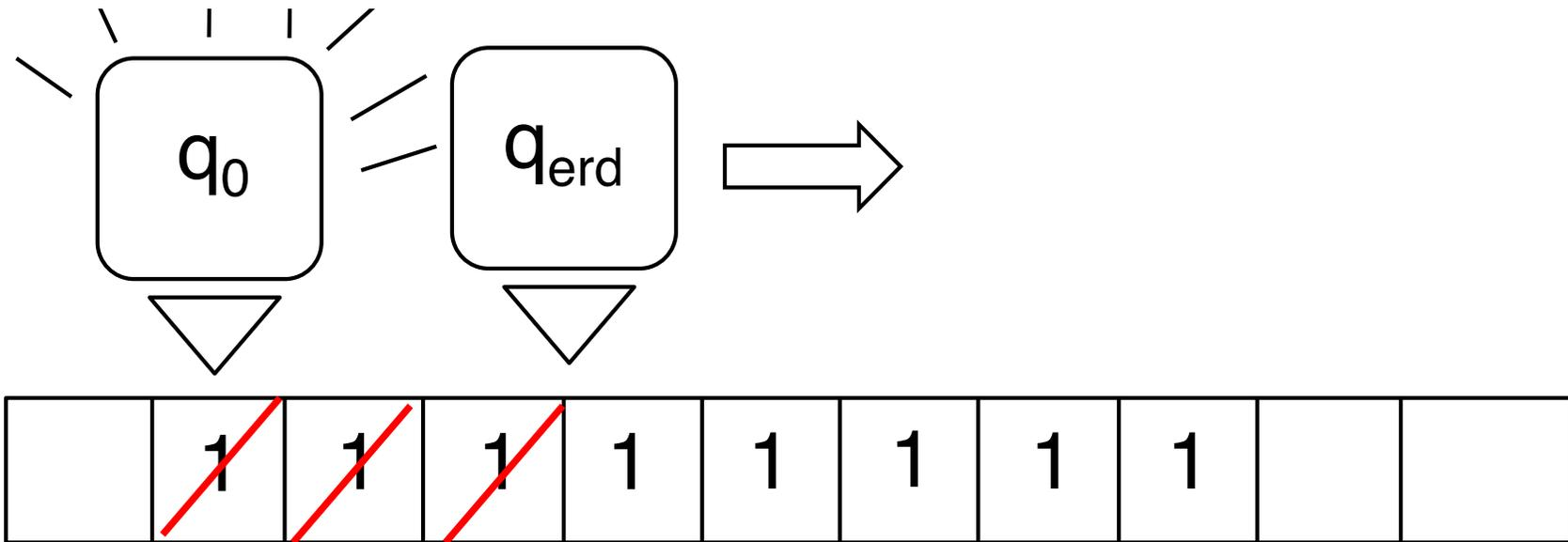
Analogamente, se ci sono più 1 che 0, quando la MT riprende a cercare 0 nello stato  $q_0$ , se si trova un 1 sotto la testina...
