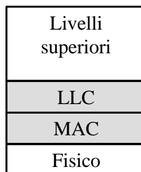
Figura 1: divisione del livello 2 di linea nei sottolivelli MAC ed RLC
